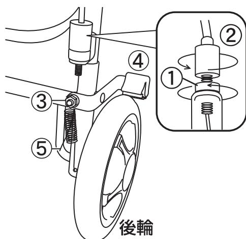
!**注意** ④ブレーキ板と車輪のすき間をせまくしすぎると、操作が固くなったり、故障の原因になります。
