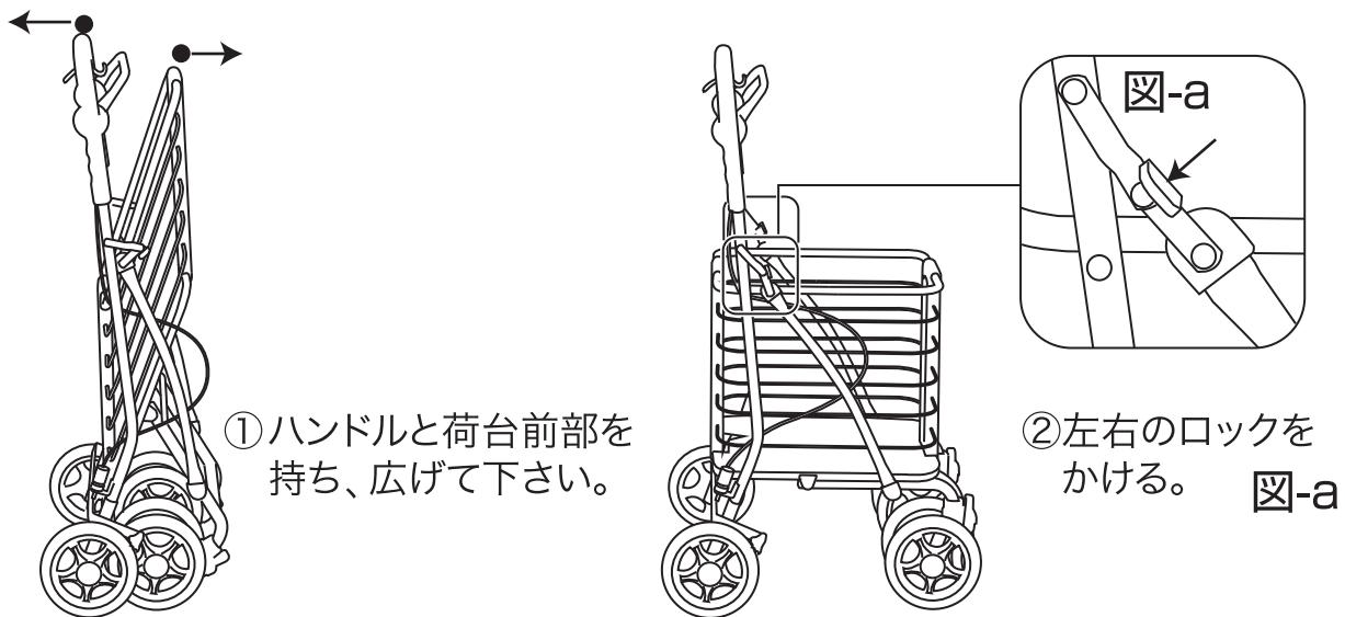
**！警告** ロック部分が「図-a」の様に固定されているか確認の上ご使用下さい。
